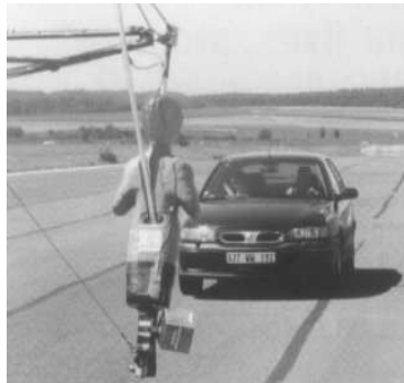
Figure 13. Test avec une cible tractée représentant un motocycliste.
