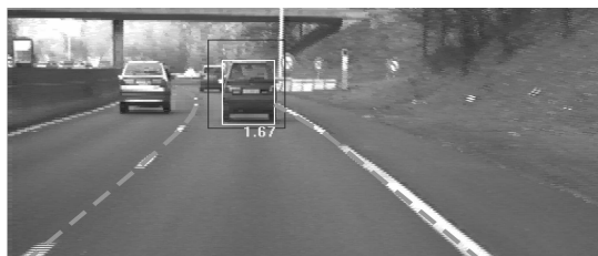
Figure 4. La détection d'obstacles et de la voie de circulation
